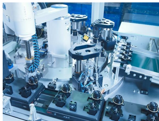
Fertigung von Schubumluftventilen der Division Pierburg am Werksstandort Neuss
